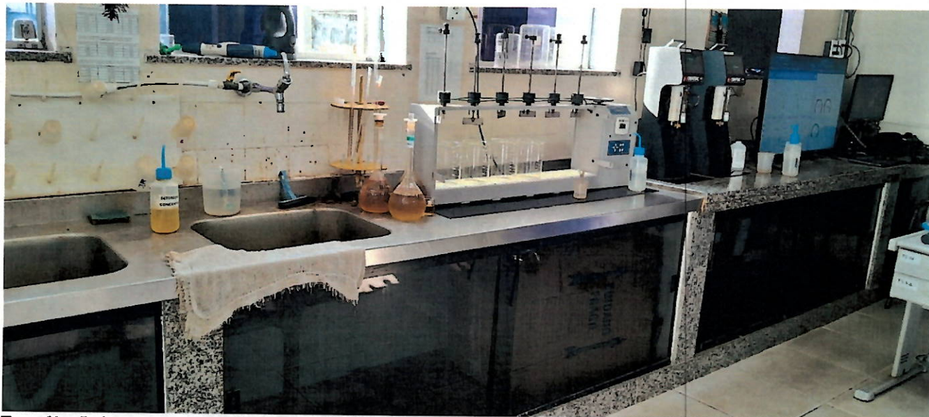
Foto 61 – Laboratório de monitoramento da água bruta onde é realizado o ensaio de jar-test.
