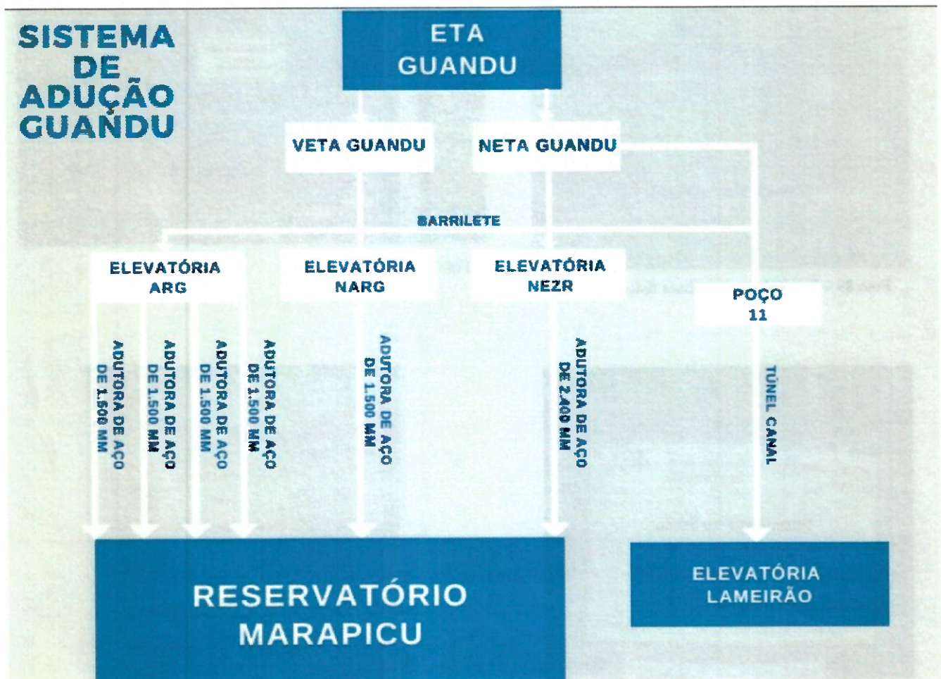
Imagem 13 – Fluxograma do sistema de adução (fonte: Plano de contingência para abastecimento de água do Guandu).
