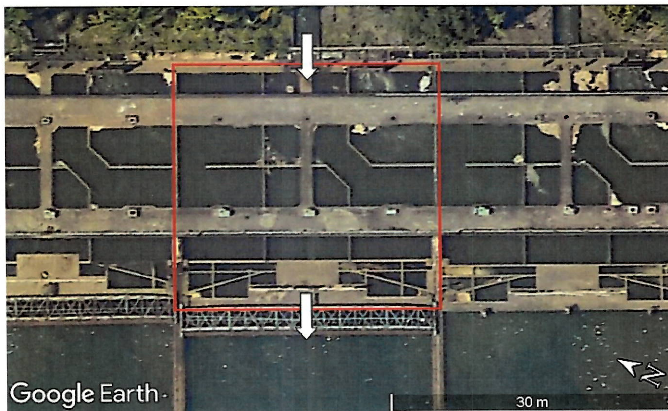
Imagem 5 – Vista superior de um dos tanques de floculação (interior do retângulo) com indicação da direção do fluxo da água em direção à decantação.
